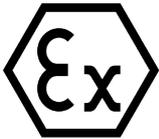
*Следить за тем, чтобы при выполнении всех работ в редукторе и на нём, отсутствовала взрывоопасная атмосфера. Соблюдать данные ATEX на заводской табличке. Выдерживать макс. допустимые температуры поверхности.*
