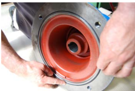
Abb. 31: O-Ring in die vorgesehene Nut eingelegt
