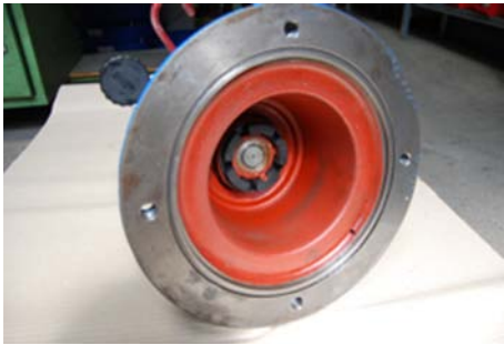
Abb. 25: Elastisches Element aufgebracht
