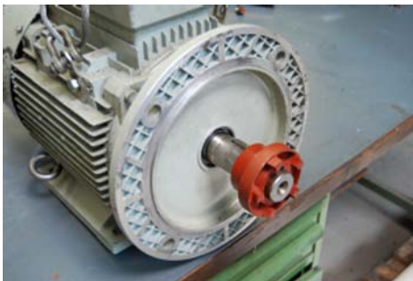
Abb. 27: Kupplungshälfte auf die Motorwelle aufgeschoben
