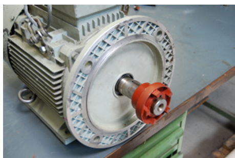
sl. 27: Polovica sklopke, potisnjena na gred motorja
