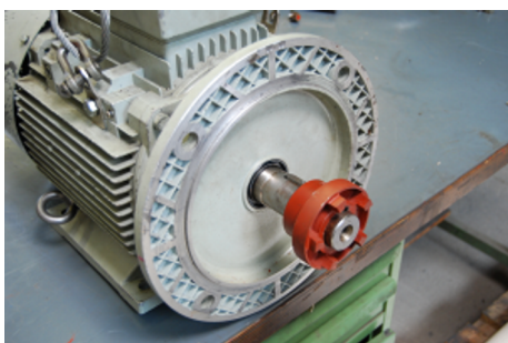
Obr. 27: Polovina spojky je nasunuta na hřídeli motoru
