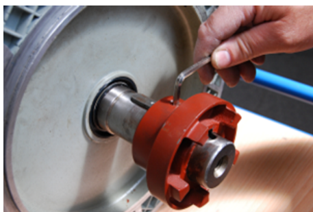
Obr. 30: Polovina spojky je axiálně upevněna
