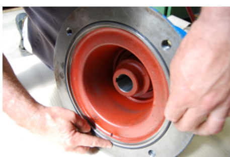
Obr. 31: Vložte O-kroužek do určené drážky
