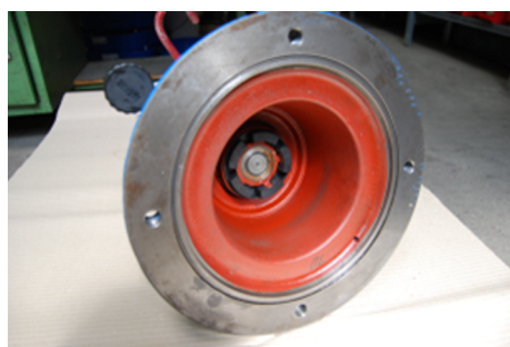
Obr. 25: Elastický prvek namontován
