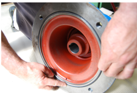
Fig. 31: O-ring inserito nella scanalatura prevista
