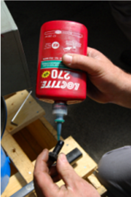
Fig. 35: Fissaggio delle viti
