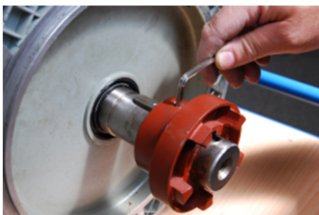
Fig. 30: Semi-giunto fissati assialmente
