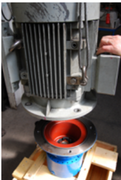
sl. 32: Montaža motorja
